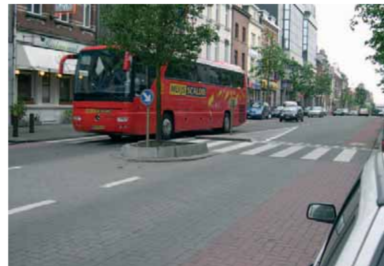
Middeneiland in stedelijke omgeving: de kop van het middeneiland op het verhoogde kruispunt is agressiever dan in de andere richting. Dit is te rechtvaardigen door het beoogde verschil in snelheid. Het middeneiland fungeert als rustpunt voor de overstekende voetganger én als poorteffect.
